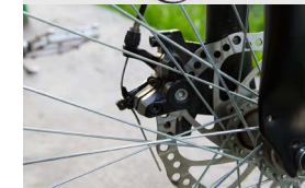
山地车刹车转子。AISI 410- EN 1.4006 不锈钢
